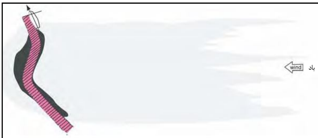
شکل ۲-۲۶- شناور در حال اسپری کردن دیسپرانت با زاویه بر روی لکه نفتی (REMPEC, 2011)
