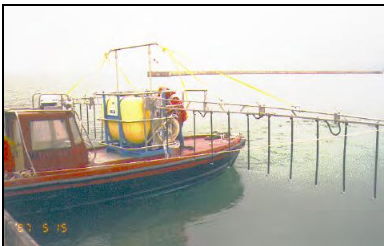
شکل ۲-۳- سیستم اسپری دیسپرسنت معمولی در قایق‌ها (REMPEC, 2011)
