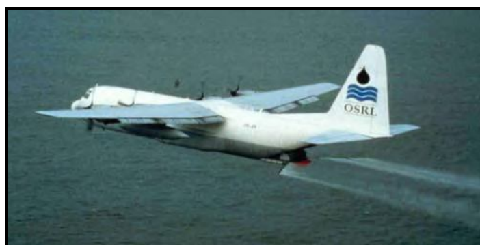
شکل ۲-۷- سیستم‌های پاششی هوابرد (با ۲۰ تن ظرفیت) (REMPEC, 2011)
